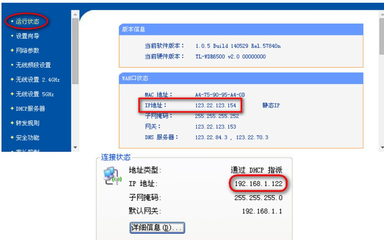
然后设置端口和 IP 地址：外部端口为模块设置端口，内部端口为本地计算机的端口，IP 地址为本地计算机的 IP 地址。
