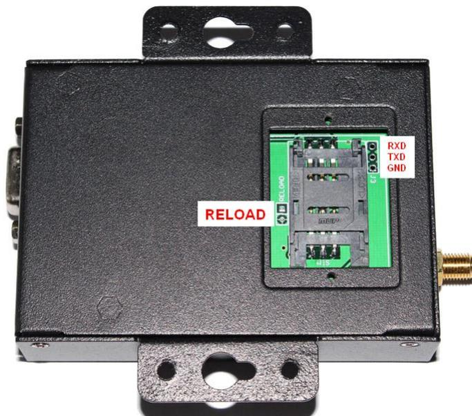
背面为：SIM 卡插槽；RELOAD 接口（通电工作状态下，短接 1 秒恢复默认设置，短接 3 秒以上恢复出厂设置）；固件升级接口。
