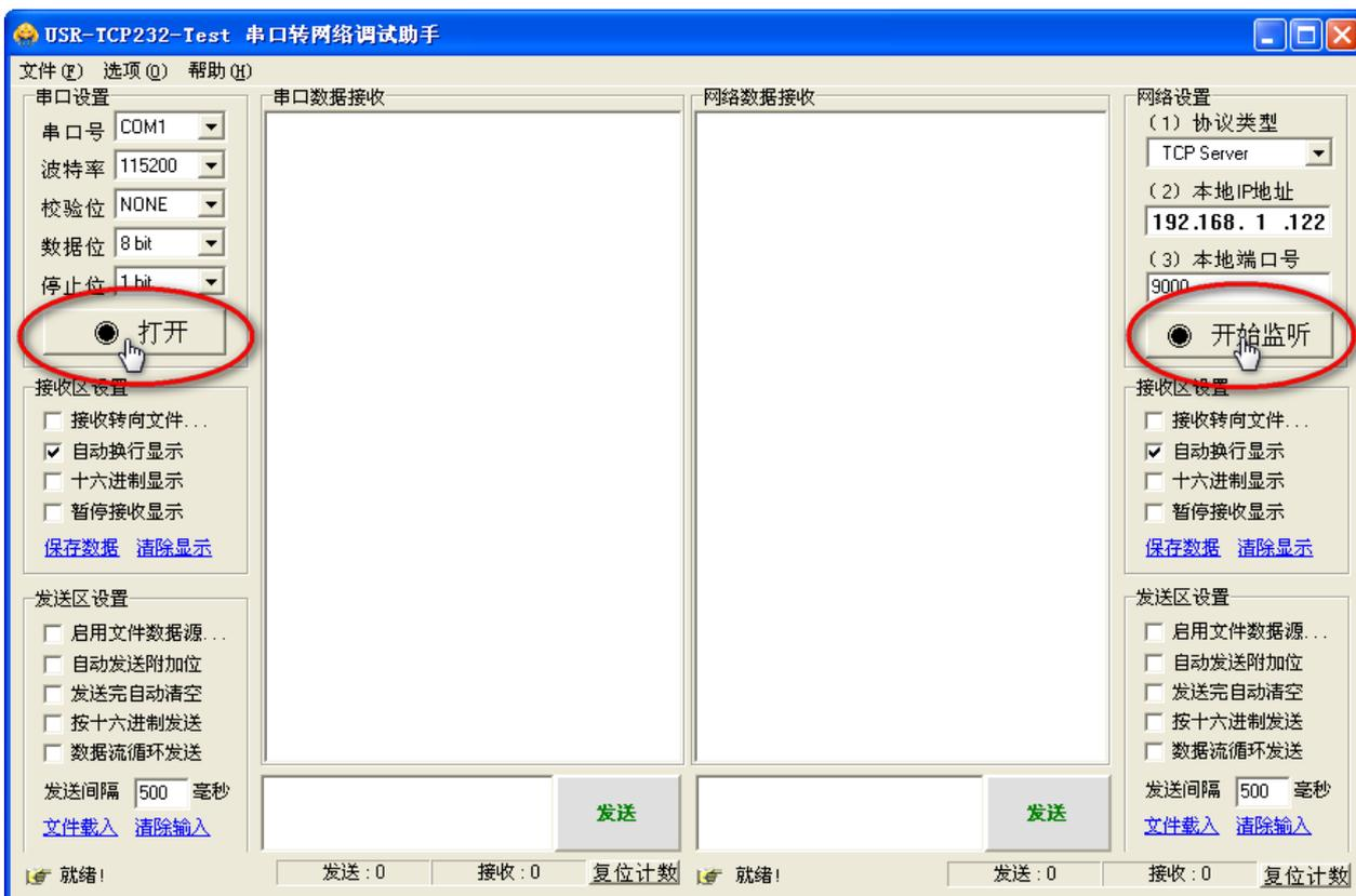
连接成功后在网络数据接收窗口的下方会显示连接对象:
