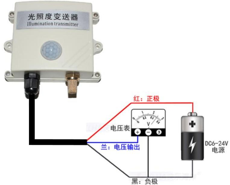
测量电压 V、量程 A 及光照度值 L 的关系:
